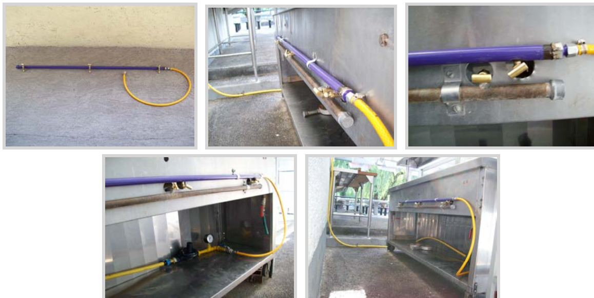
Figura V.11 – Componentes del sistema de suministro de biogás al equipo de combustión Arriba a la izquierda, tubo para la distribución del biogás a los quemadores; arriba al centro, instalación del tubo en la cocinilla; arriba a la derecha, detalle de las llaves; abajo a la izquierda, regulador de presión y manómetro; abajo a la derecha, vista de la cocinilla con las modificaciones practicadas para el uso del biogás
