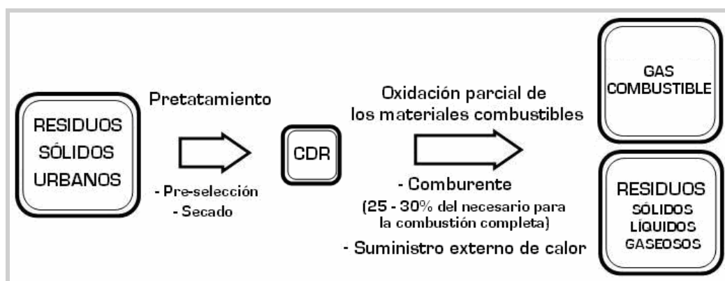
Figura I.12 - Esquema simplificado de la gasificación de los residuos sólidos urbanos (Elaboración a partir de INE-SEMARNAT, 2001b)
